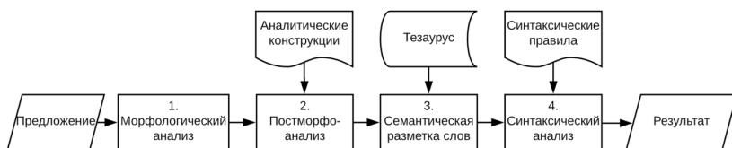
Рис. 2. Последовательность работы анализатора
